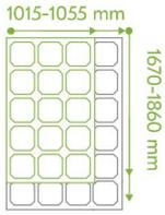
Das System ist für Module mit einer Breite von 1015-1055 mm und einer Länge von 1670-1860 mm ausgelegt.
